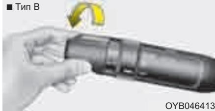
Когда переключатель освещения находится в положении фары (3-ое положение), включаются задние фонари, освещение номерного знака и подсветка приборной панели.
