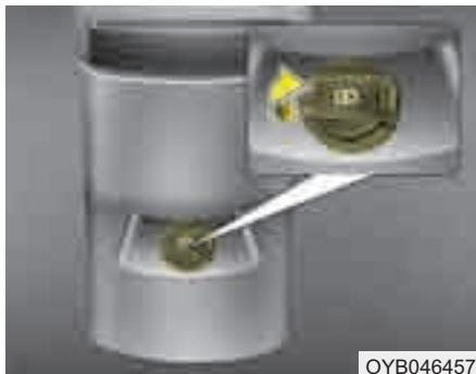
Зарядное USB-устройство предназначено для зарядки аккумуляторов различных гаджетов через USB-кабель. Зарядку электрических устройств можно производить, когда кнопка пуска/останова двигателя находится в положении ACC/ON/START.
