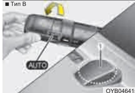
Когда переключатель управления световыми приборами находится в данном положении, включение и выключение фар и габаритных огней будет производиться автоматически в зависимости от уровня освещенности снаружи автомобиля.
