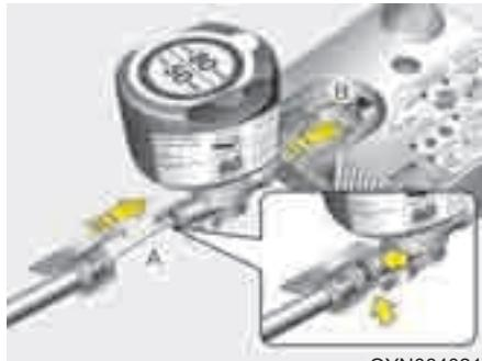
4. Подсоедините заливочный шланг (3) к разъему бутылки с герметиком (A).
