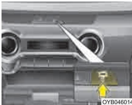
Он работает при нажатии на выключатель блокировки/разблокировки двери.
