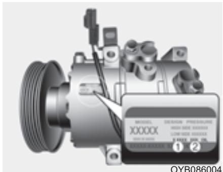
На этикетке компрессора указаны модель, номер детали поставщика, серийный номер, тип хладагента (1) и тип холодильного масла (2).
