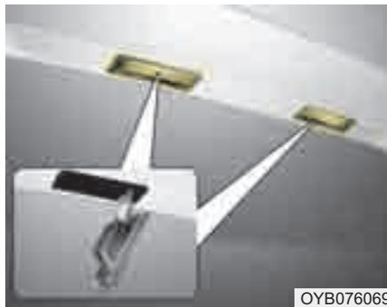
1. Осторожно снять отверткой для винтов и шурупов с прямым шлицем рассеиватель с корпуса фонаря.
