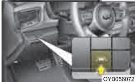
Данная система регистрирует полосу движения с помощью датчика на ветровом стекле и предупреждает водителя при выезде за полосу.
