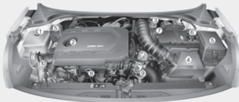
1. Резервуар для охлаждающей жидкости двигателя
