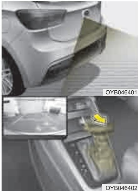
Данная система является вспомогательной и предназначена для вывода изображения обстановки позади двигающегося задним ходом автомобиля на монитор навигационной системы.
