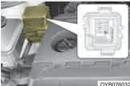
Под крышкой панели плавких предохранителей и реле находится табличка с наименованиями предохранителей/реле и величинами их номинальных токов.
