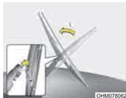
1. Поднимите рычаг стеклоочистителя (1) и извлеките узел щетки.
