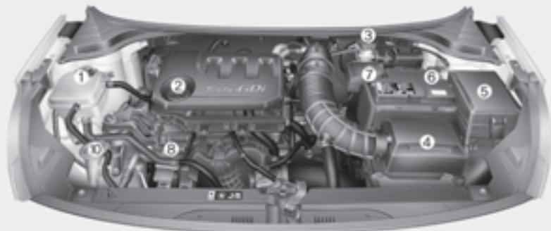
1. Резервуар для охлаждающей жидкости двигателя
