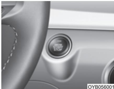
При открывании передней двери включается подсветка кнопки запуска и остановки двигателя. Она отключается через 30 секунд после закрытия двери. Подсветка кнопки отключается незамедлительно, когда включается противоугонная сигнализация.
