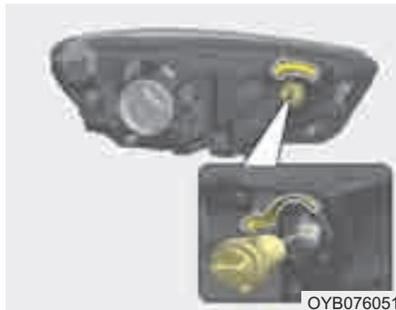
5. Установите патрон в блок фары, совместив выступы на патроне с прорезями на блоке. Вставьте патрон в узел, после чего поверните патрон по часовой стрелке.
