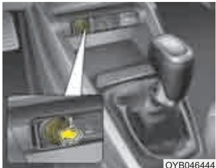
Для работы прикуривателя ключ в замке зажигания должен находиться в положении ACC или ON.
