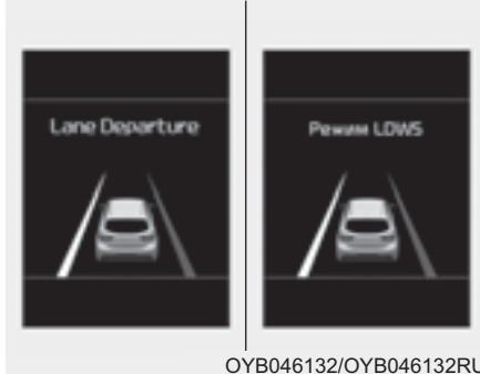
В этом режиме отображается состояние системы предупреждения о покидании полосы движения (LDWS).
