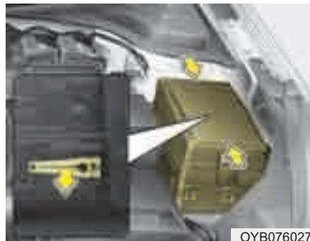
3. Извлеките предположительно неисправный предохранитель. Для этого воспользуйтесь специальным приспособлением, которое находится в основном блоке предохранителей в моторном отсеке.
