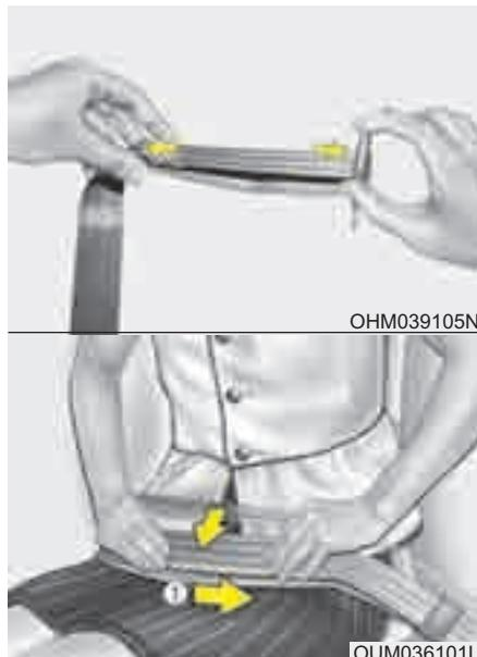
Регулировка длины двухточечного ремня для того, чтобы он плотно облегал тело пассажира, производится вручную. Застегните ремень и натяните его, потянув за его свободный конец. Ремень должен быть расположен как можно ниже на бедрах (1), а не на талии.
