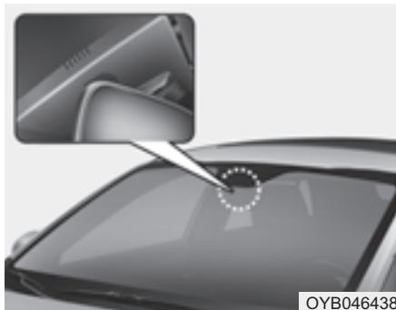
Автоматическая система устранения запотевания снижает возможность запотевания внутренней поверхности лобового стекла, автоматически определяя наличие влаги и увеличивая поток воздуха по направлению к лобовому стеклу.
