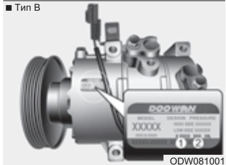
На этикетке компрессора указаны модель, номер детали поставщика, серийный номер, тип хладагента (1) и тип холодильного масла (2).
