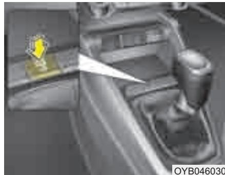
Если включено зажигание, то при нажатии кнопки подогрева рулевого колеса будет включен обогрев рулевого колеса. На кнопке загорится световой индикатор.
