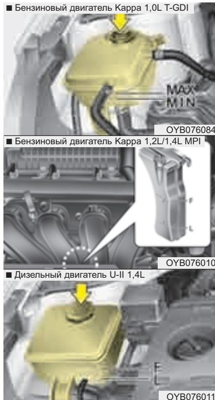
Проверьте состояние и соединения всех шлангов систем охлаждения и обогрева. Замените все вздувшие или изношенные шланги.
