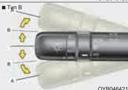
Для работы указателей поворота зажигание должно быть включено. Для включения указателей поворота переместите рычаг вверх или вниз (A). Зеленые лампы в форме стрелок на приборной панели укажут, какой именно указатель поворота работает.
