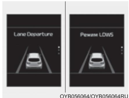
При выборе экрана информации о поездке на ЖК-дисплее отображается режим работы системы LDWS.
