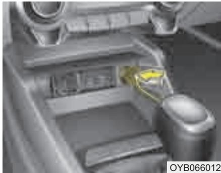
9. С помощью кабеля и разъемов выполните подключение между компрессором и розеткой питания автомобиля.
