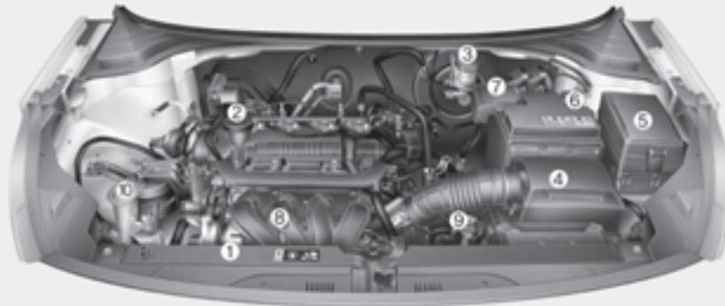
1. Резервуар для охлаждающей жидкости двигателя
