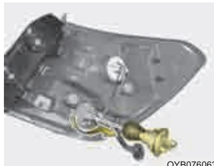
5. Извлеките патрон, поворачивая его против часовой стрелки до тех пор, пока выступы на патроне не совпадут с прорезями на узле.
