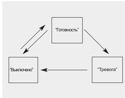
Эта система предназначена для защиты автомобиля от несанкционированного проникновения. В работе системы существуют три этапа: первый этап называется "Готовность", второй - "Тревога", третий этап - "Выключено". Во сработавшем состоянии системы противоугонной сигнализации подает звуковой тревожный сигнал одновременно с миганием огней аварийной сигнализации.
