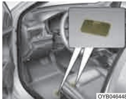
При использовании напольного коврика на напольном покрытии под передним креслом убедитесь, что он закреплен с помощью фиксатора (ов) для напольных ковриков автомобиля. Это позволит предотвратить соскальзывание коврика вперед.
