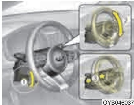
Для изменения угла наклона рулевого колеса опустите вниз рычаг блокировки (1), откорректируйте угол (2) и высоту (3, при наличии) наклона рулевого колеса, затем поднимите рычаг блокировки, чтобы зафиксировать рулевое колесо. Установить рулевое колесо в желаемое положение необходимо до начала движения.
