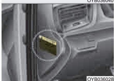
Такие этикетки размещены для предупреждения водителя и пассажиров о потенциальной опасности системы подушек безопасности.
