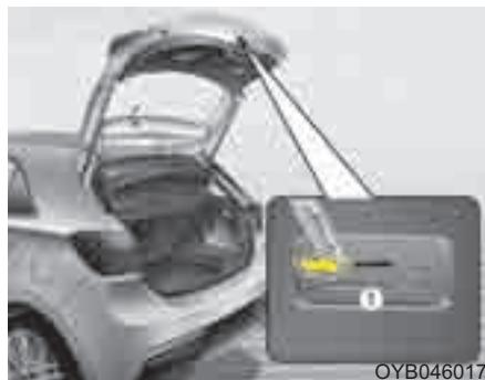
Автомобиль оснащен устройством аварийного отпирания крышки багажника, расположенным в ее нижней части. Порядок открытия крышки багажника при случайном запирании себя внутри багажника.
