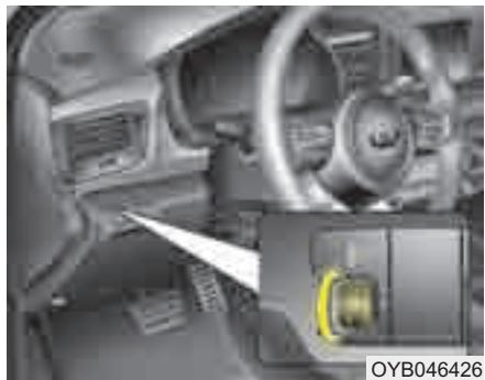
Для регулировки угла наклона фар в соответствии с количеством пассажиров и весом груза в багажнике следует повернуть ручку регулятора угла наклона фар.
