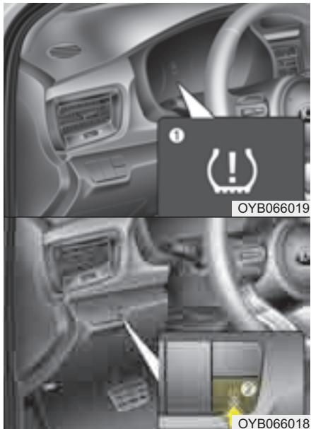
Сигнал низкого давления в шинах (1) / Переключатель настройки системы TPMS (2)
